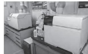
ICP質量分析装置(ICP/MS)
